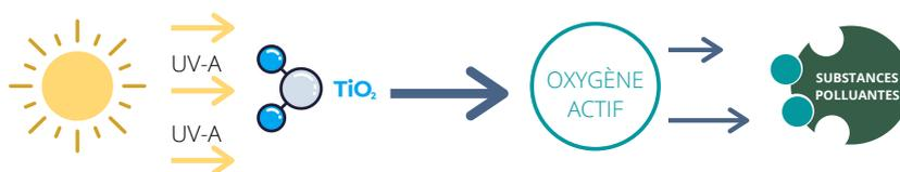
**L'efficacité** du système photocatalytique est **immédiate**, tous les composés organiques et non organiques, entrant en contact avec la surface photocatalytique, sont immédiatement oxydés et éliminés. Cette fonction appliquée par l'appareil Safety 50 permet de rendre l'environnement sain très **rapidement** grâce à la grande capacité de recirculation de l'air.
